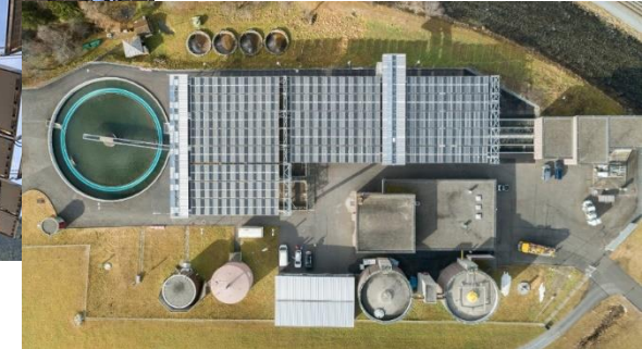
Beispiel: solares Faltdach für die Kläranlage Davos
