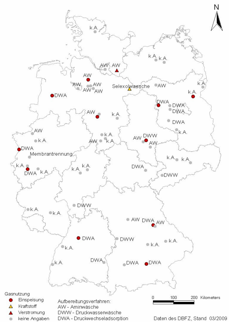
Abbildung 3-12 Standorte der Biogasaufbereitungsanlagen in Deutschland mit Kennzeichnung des Anlagenstatus (links) sowie des Aufbereitungsverfahrens mit Angabe der Gasnutzung (rechts)
