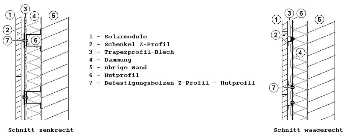
Abbildung 1: Aufbau der Fassade (vereinfacht, nicht maßstäblich)
